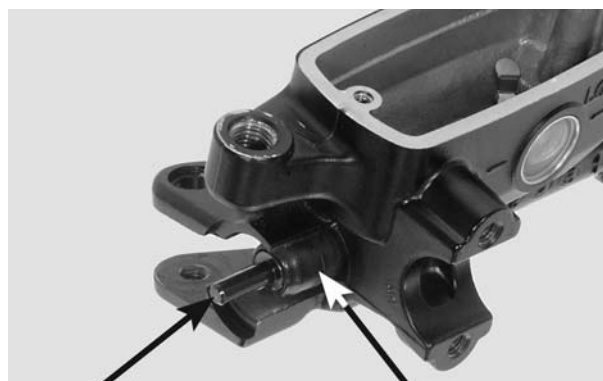
HASTE DE ACIONAMENTO PROTETOR PARAFUSO
