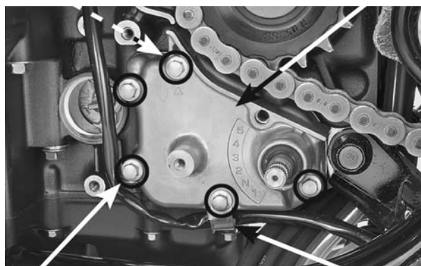
PARAFUSOS PRESILHA DA FIAÇÃO JUNTA
