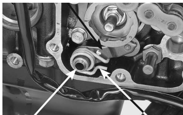
ESPAÇADOR MOLA DE RETORNO PLACA-GUIA LINGÜETA ÊMBOLO DA CATRACA
