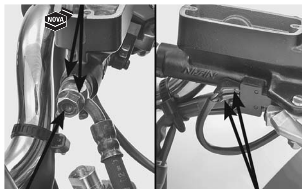
PARAFUSO DE ÓLEO CONECTORES DO INTERRUPTOR PARAFUSOS ARRUELAS DE VEDAÇÃO BORRACHA
