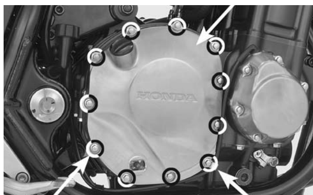
PARAFUSOS PRESILHA DA FIAÇÃO
