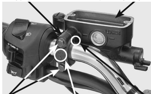
PARAFUSOS MARCA "UP" ARRUELAS DE VEDAÇÃO
