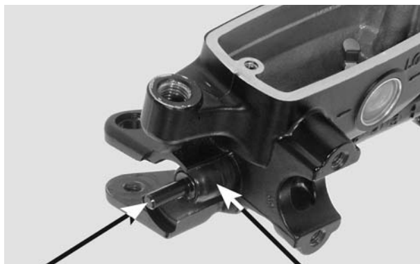
HASTE DE ACIONAMENTO ANEL ELÁSTICO
