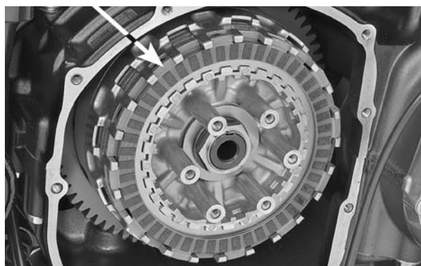
HASTE DE ACIONAMENTO DISCOS/SEPARADORES DA EMBREAGEM
